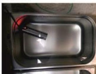
УЗ-излучатель в емкости
