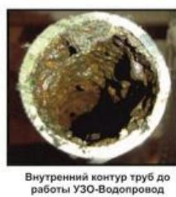
Внутренний контур трубы до работы УЗО-Водопровод и после
