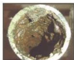
Внутренний контур труб до работы УЗО-Водопровод и после
